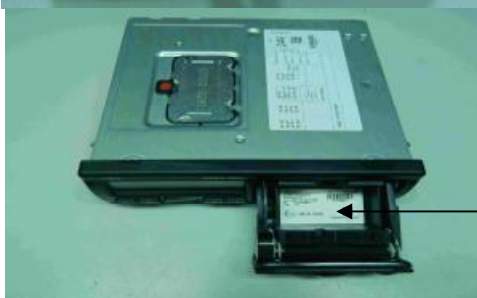
Рисунок 2 – Схема пломбировки от несанкционированного доступа и место нанесения знака об утверждении типа
