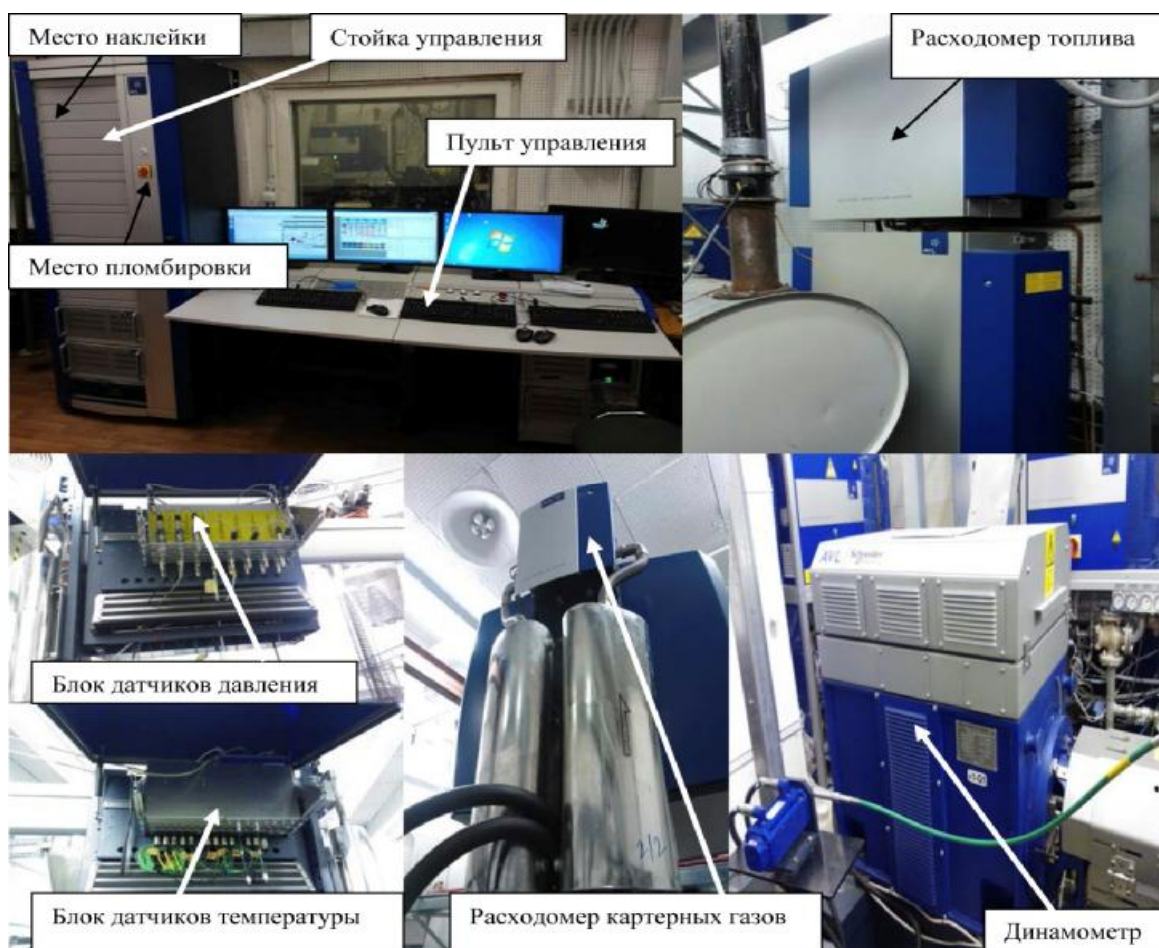
Рисунок 1 - Общий вид Системы и место пломбировки от несанкционированного доступа
