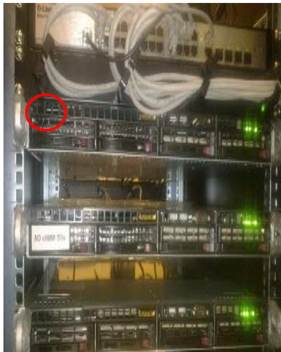
Рисунок 2 Карты коммутации и управления (выделено место блокировки кассет)
