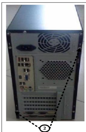
Примечание: ② - места пломбировки от несанкционированного доступа.
