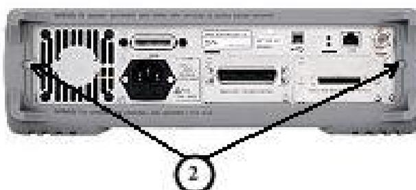
Примечание: ② - места пломбировки от несанкционированного доступа.
