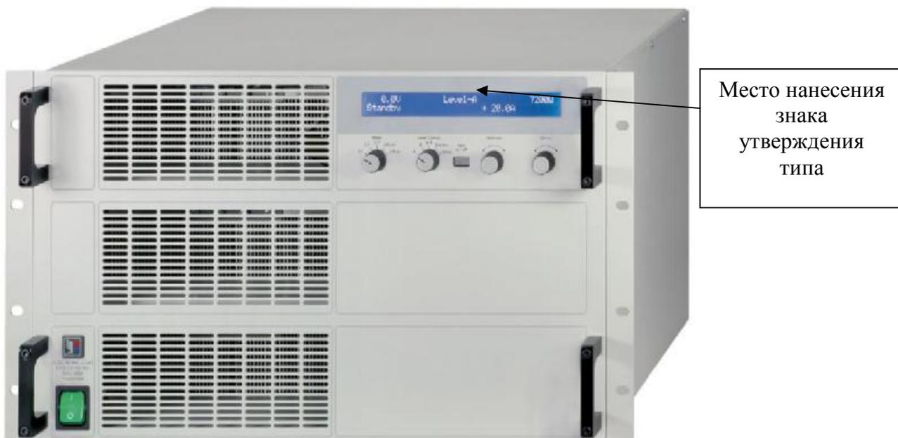
Рисунок 7 – Внешний вид нагрузок EA-EL 9000 для мощности 7200 Вт
