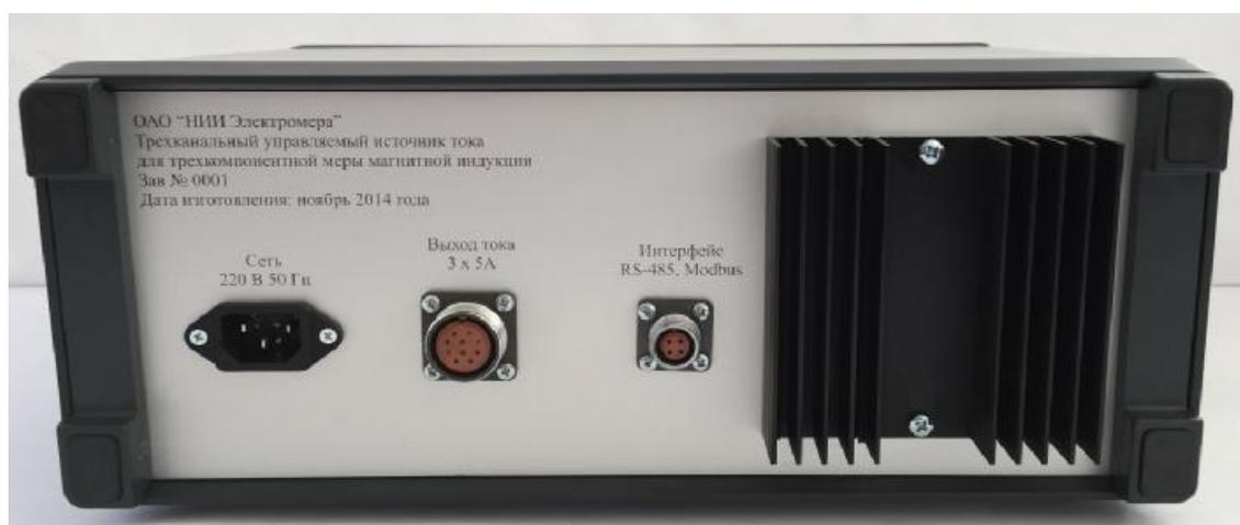
Рисунок 3 – Вид задней панели трехканального управляемого источника тока
