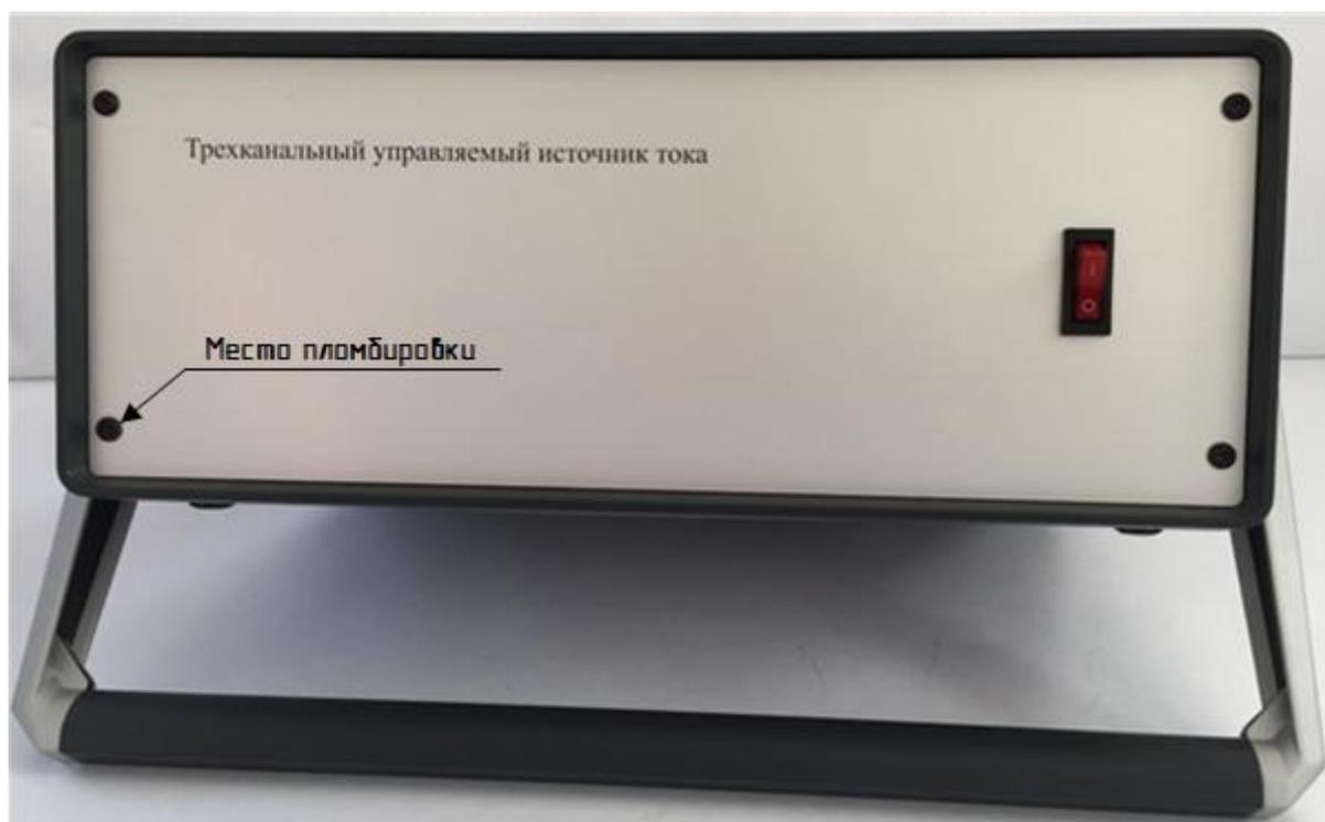
Рисунок 2 – Общий вид трехканального управляемого источника тока со схемой пломбировки от несанкционированного доступа
