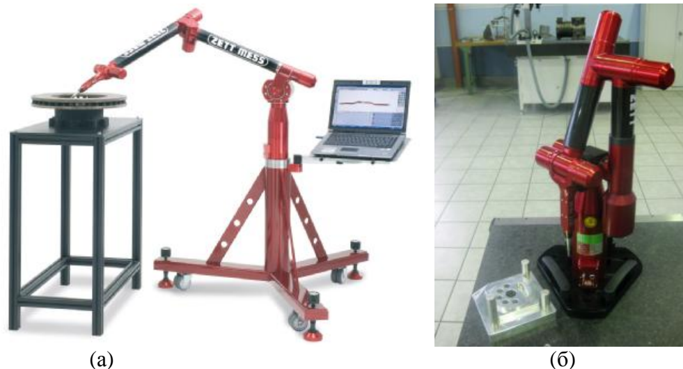
Рисунок 1 - Общий вид машин координатно-измерительных мобильных серии AMPG (а) и серии Gauge (б)
