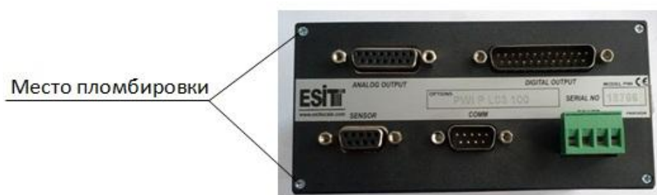
Рисунок 8 — Место пломбировки индикатора PWI-P (пломбировка мастикой в пломбировочной чашке или разрушаемой наклейкой)
