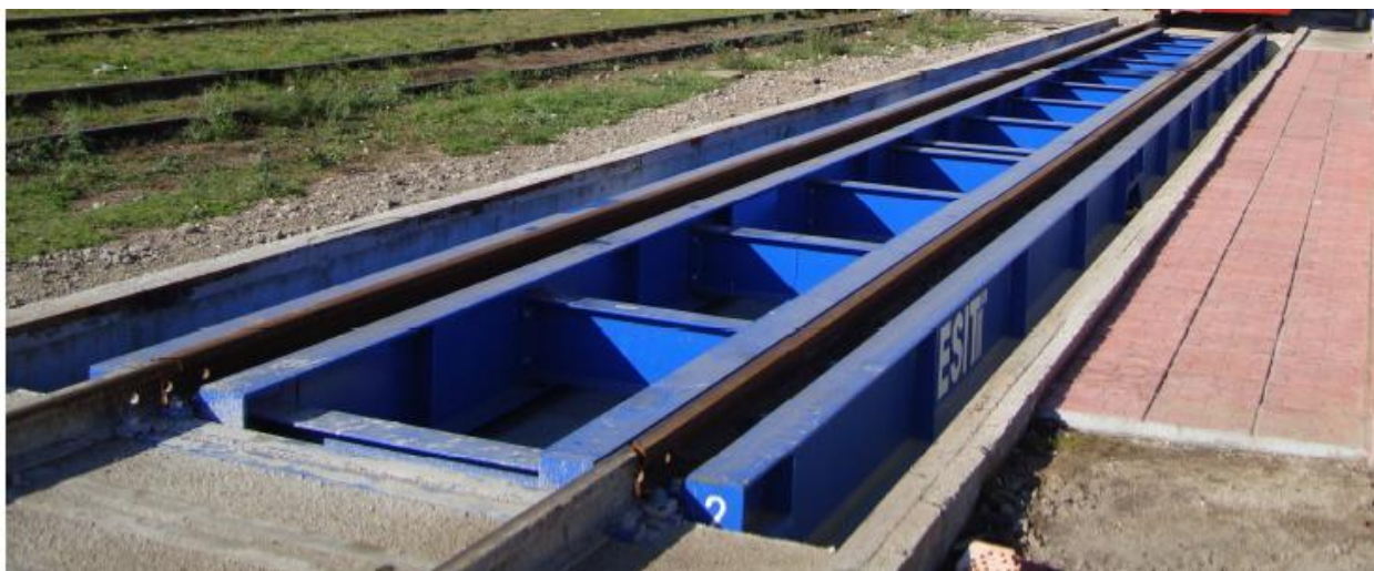
Рисунок 1 — Общий вид ГПУ весов
