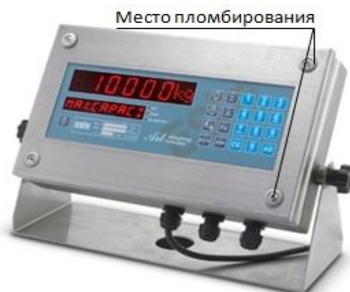
Рисунок 5 — Место пломбировки индикатора ART-S (пломбировка мастикой в пломбировочной чашке, свинцовой пломбой или разрушаемой наклейкой)
