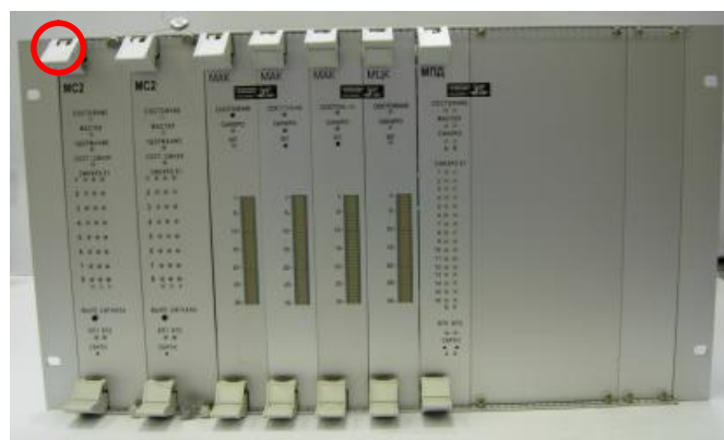
Рисунок 2 – Схема кассетного модуля и место блокировки модуля
