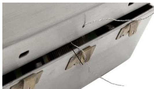
Рисунок 5 – Места пломбирования корпуса терминалов
