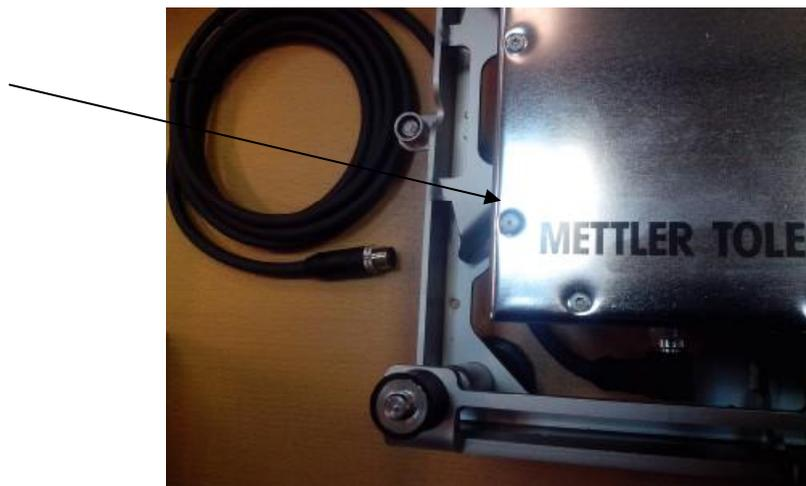
Рисунок 6 – Место установки "срывного" винта на крышке датчика
