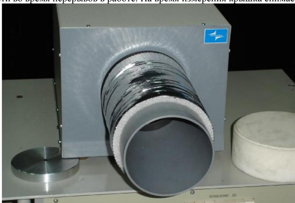
Рисунок 3 - Тепловой излучателя МЧТ прецизионной с навинченным тубусом
