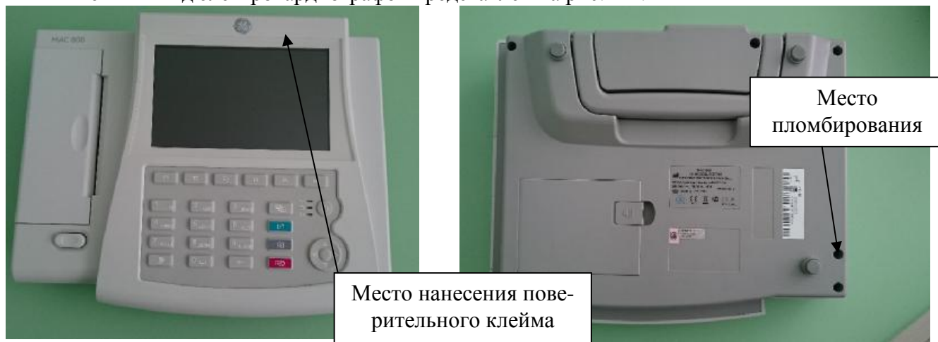
Рисунок 1 - Электрокардиограф МАС 800. Вид спереди
