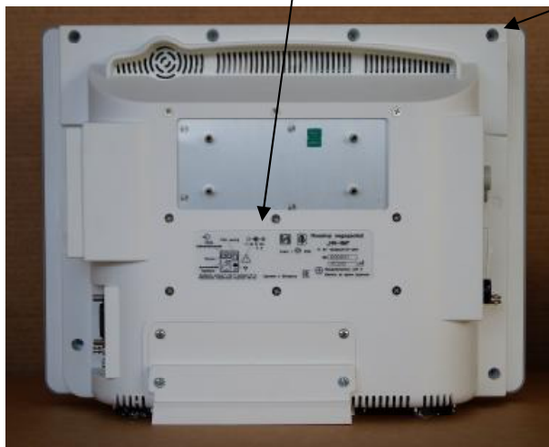
Рисунок 2 – Места нанесения знака утверждения типа и пломбирования
