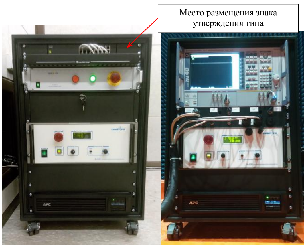
Рисунок 4 – Внешний вид векторного анализатора цепей, контроллеров, предназначенных для управления работой сканера и ОПУ
