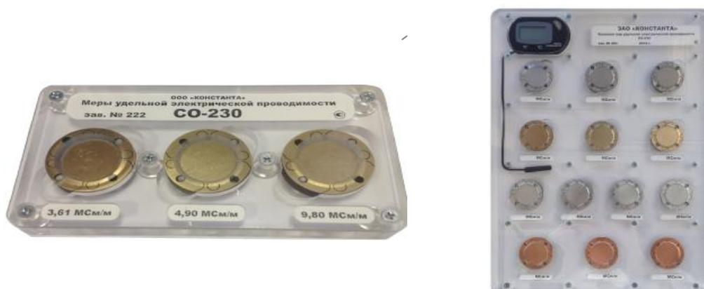
Рисунок 1 - Меры удельной электрической проводимости СО-230
