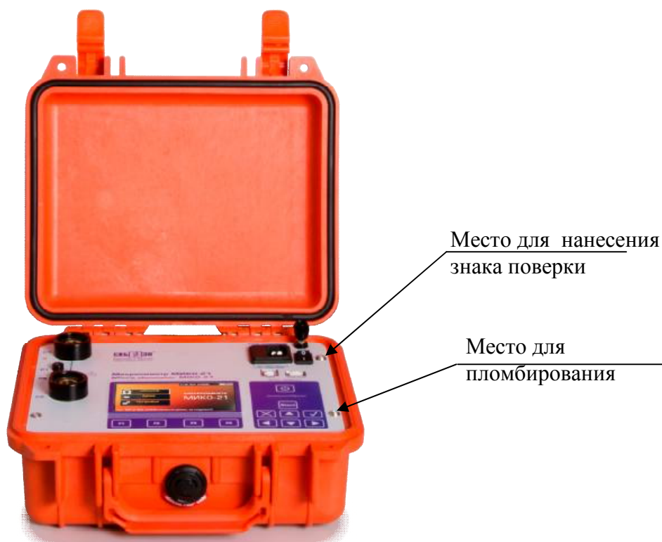
Рисунок 1 - Внешний вид микроомметра МИКО-21
