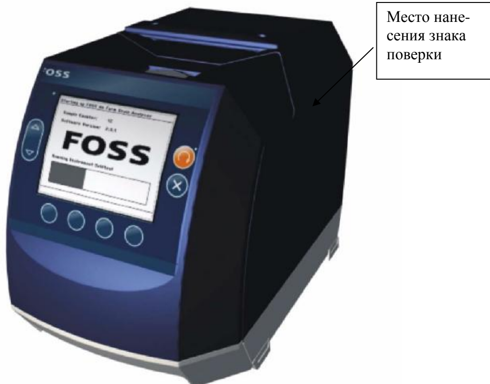
Рисунок 2 - Внешний вид анализатора «Infracos Sofia»
