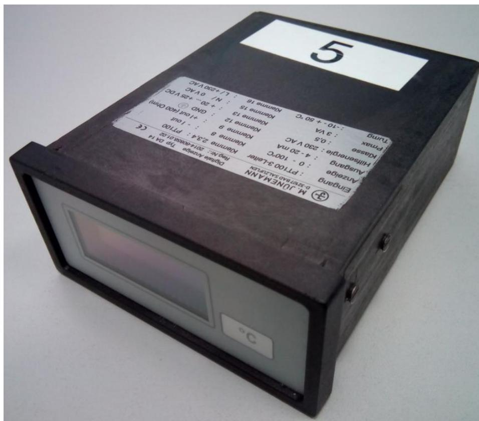
Рисунок 1 - Внешний вид преобразователей температуры измерительных DA14
