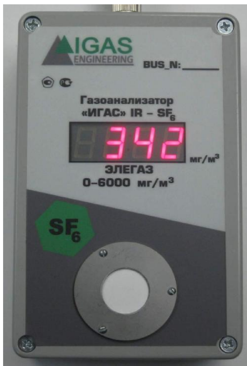
Рисунок 1 – Внешний вид газоанализатора
