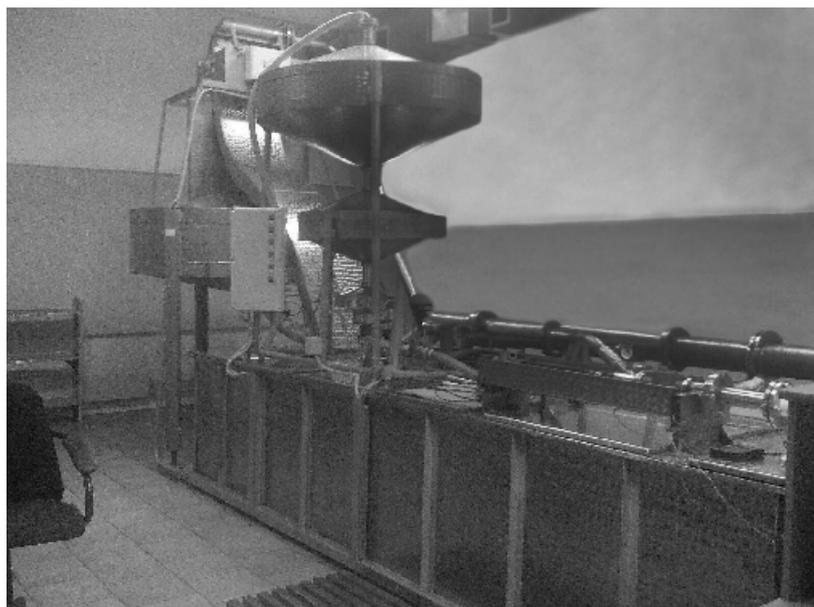
Рисунок 1 – Общий вид установки поверочной автоматизированной АКВА-200АМ
