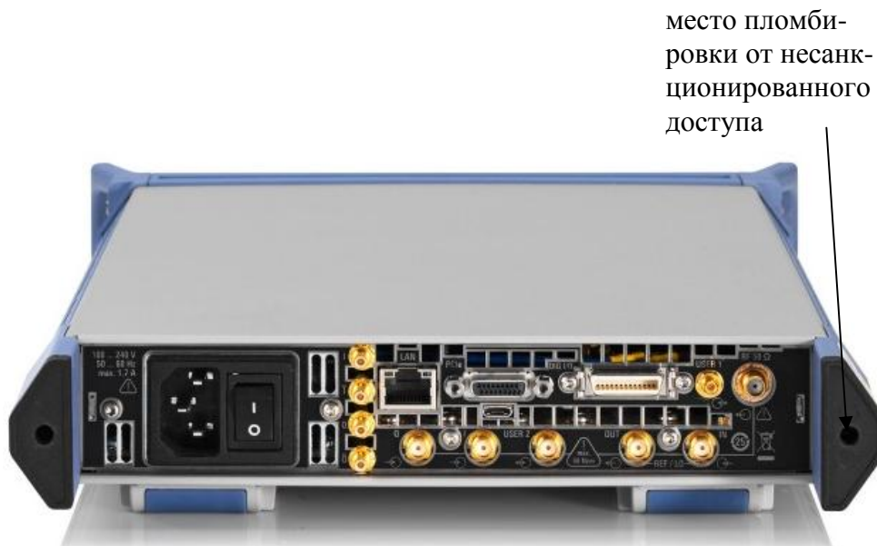
Рисунок 2 - Схема пломбировки от несанкционированного доступа
