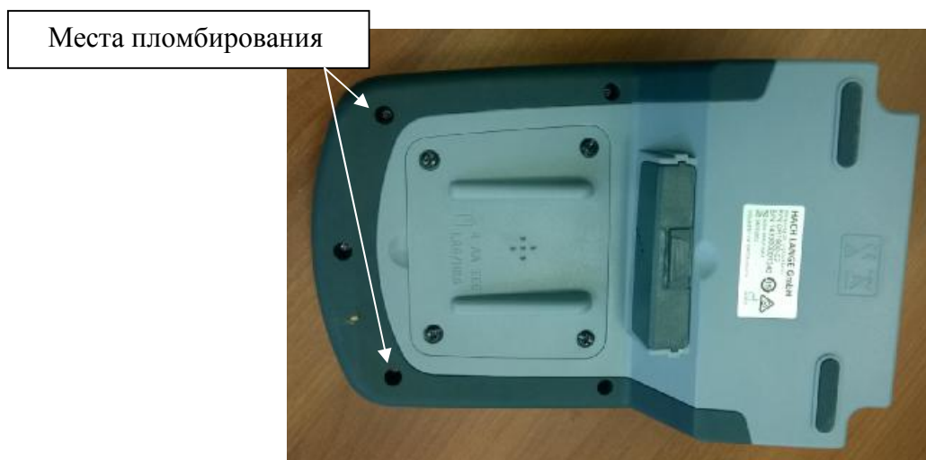
Рисунок 2 – Места пломбирования спектрофотометров DR 1900 (вид снизу)
