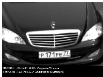
Рисунок 2 - Кадр фотофиксации, с внесенными обязательными данными о результатах измерений, заводском номере АПК, дате и месте установки
