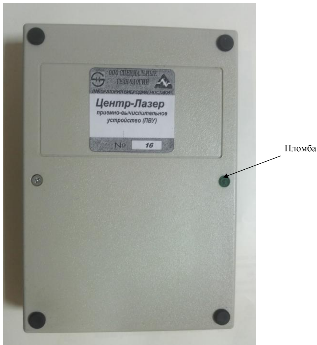
Рисунок 2 - Место пломбирования крепёжных винтов корпуса приемно-вычислительного блока
