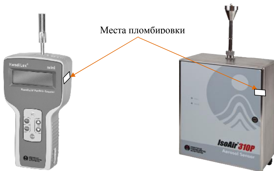
Рисунок 6 - Схемы пломбировки счетчиков счетчиков Lasair III
