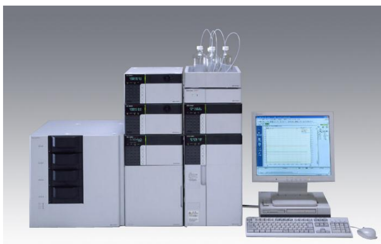
Рисунок 1 - Фотография общего вида хроматографа жидкостного Prominence
