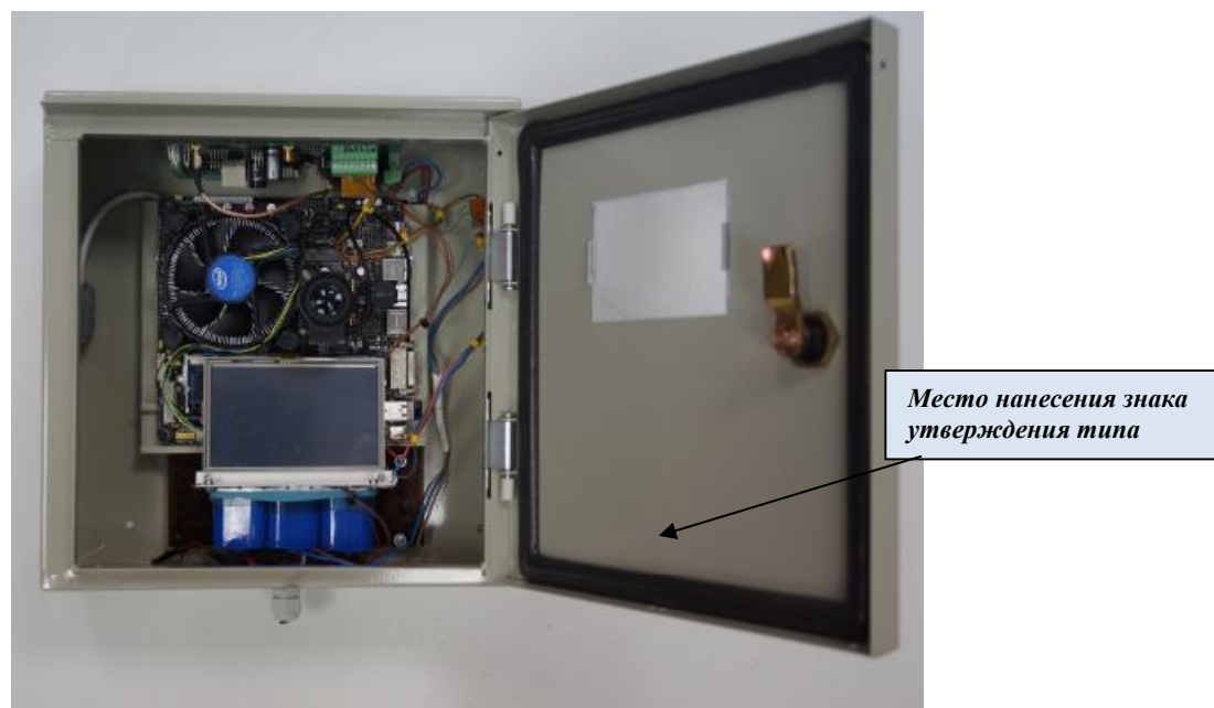
Рисунок 6 – Вид комплекса «Орлан-Р» с открытой крышкой
