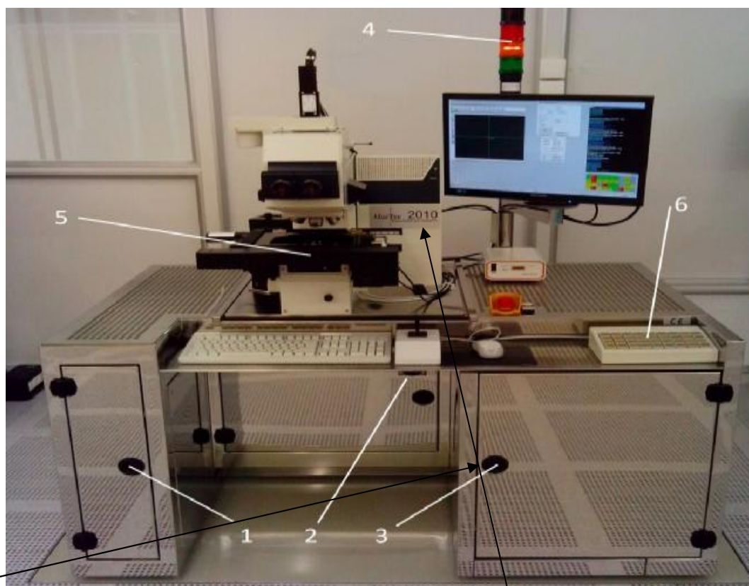
Место пломбировки от несанкционированного доступа. Место для размещения наклеек (знака поверки и знака утверждения типа)
