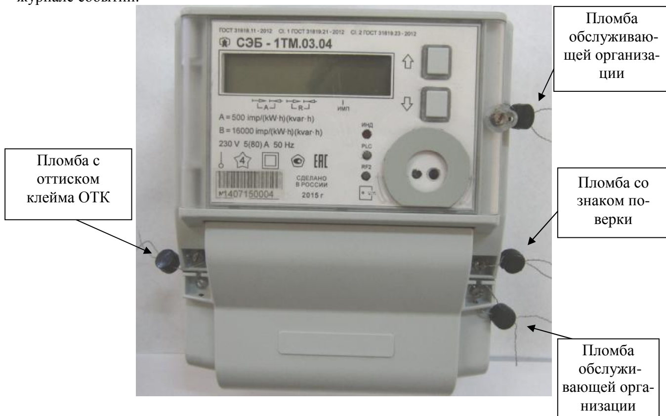
Рисунок 1 – Внешний вид счетчиков, предназначенных для установки внутри помещения, и схема пломбирования
