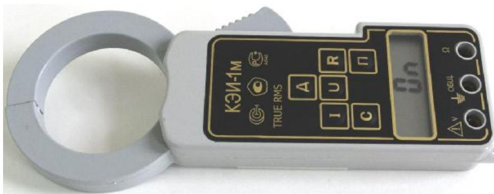
Рисунок 2 - Внешний вид клещей электроизмерительных КЭИ-1,0М. Вид сверху
