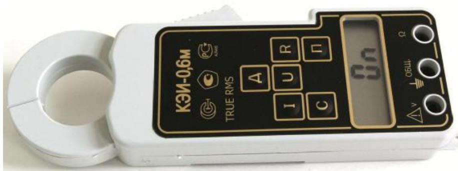
Рисунок 1 - Внешний вид клещей электроизмерительных КЭИ-0,6М. Вид сверху
