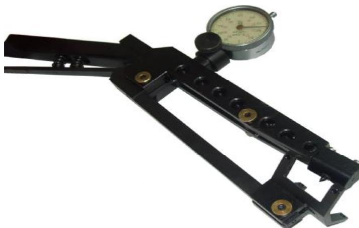
Рисунок 13 – Общий вид прибора НИИК-100/35
