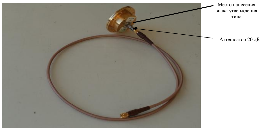
Рисунок 2– Внешний вид датчика в сборе с аттенуатором и кабелем
