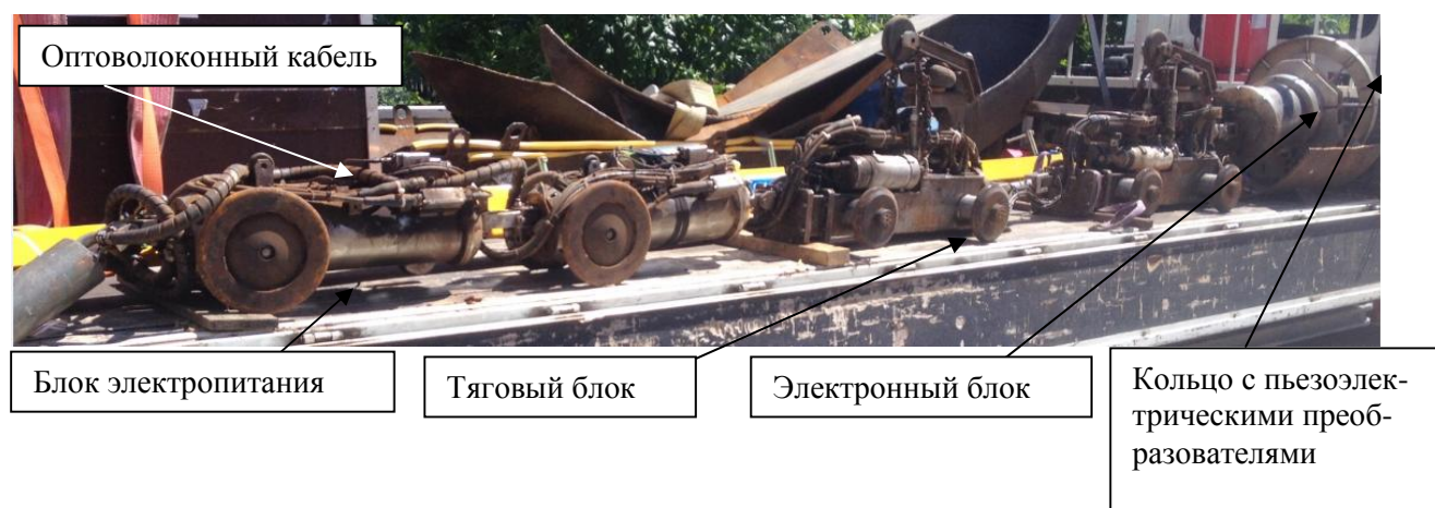
Рисунок 1 - Общий вид систем внутритрубных ультразвуковой диагностики Pipeline Inspection Tool (PIT)
