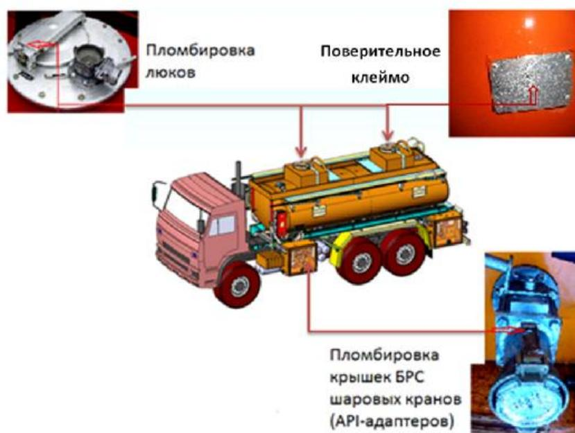
Рисунок 2 - Схема пломбировки автоцистерн СЕСПЕЛЬ-АЦ, автотопливозаправщиков СЕСПЕЛЬ-АТЗ
