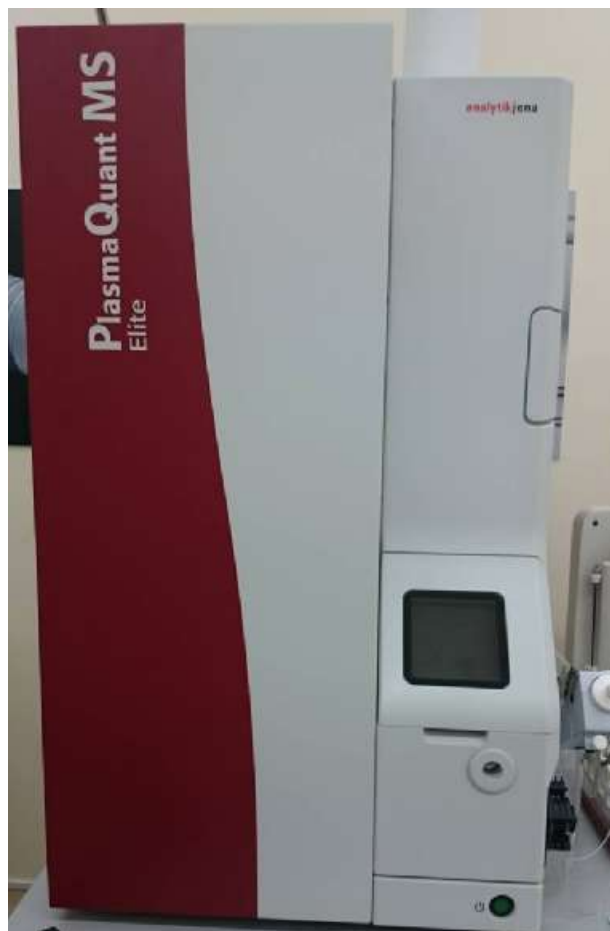
Рисунок 1 – Внешний вид масс-спектрометров с индуктивно связанной плазмой. Вид спереди
