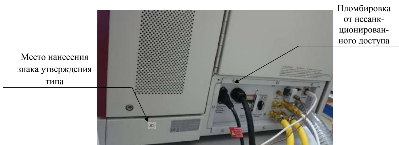
Рисунок 2 – Внешний вид масс-спектрометров с индуктивно-связанной плазмой. Вид сзади
