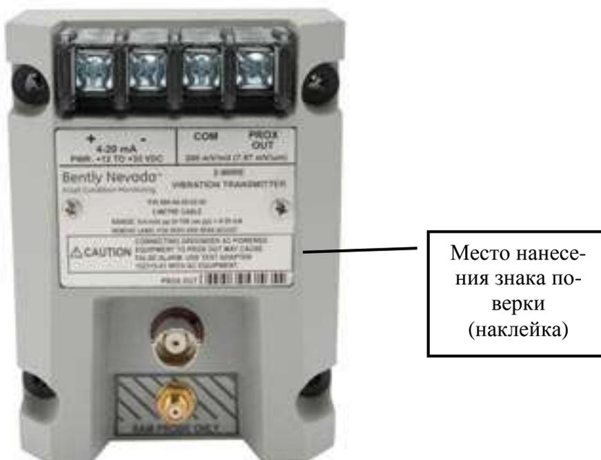
Рисунок 1 - Внешний вид трансмиттера вибрационного 990
