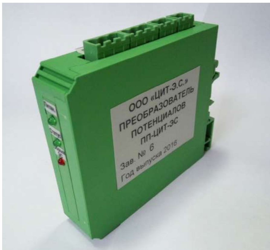
Рисунок 1 – Фотография общего вида преобразователя потенциалов ПП-ЦИТ-ЭС
