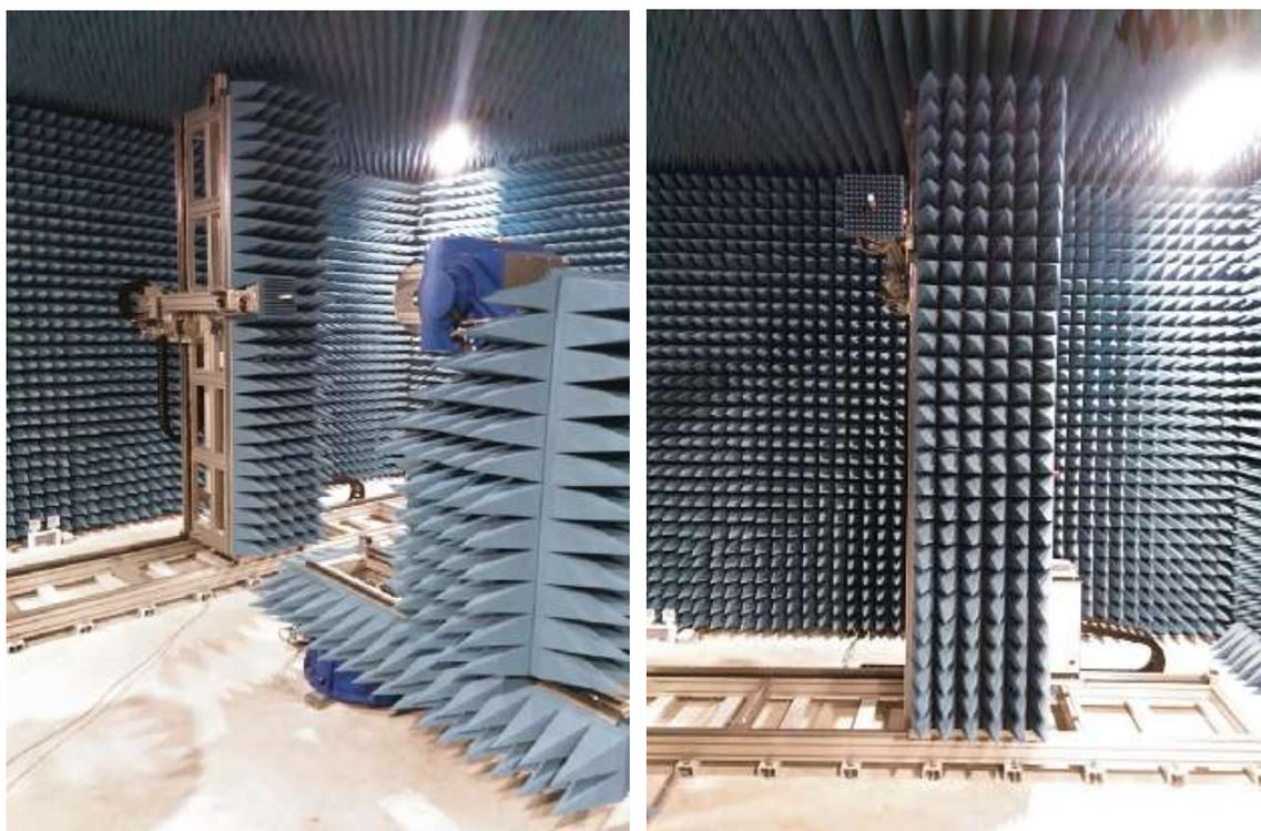
Рисунок 1 – Внешний вид сканера с антенной-зондом
