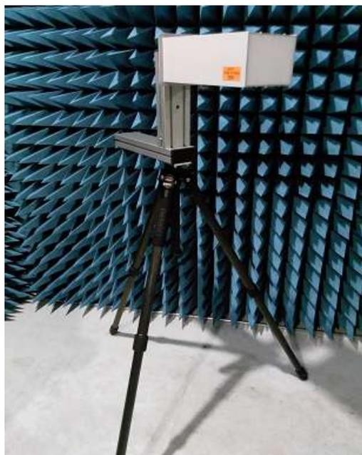
Рисунок 3 – Внешний вид рупорной антенны
