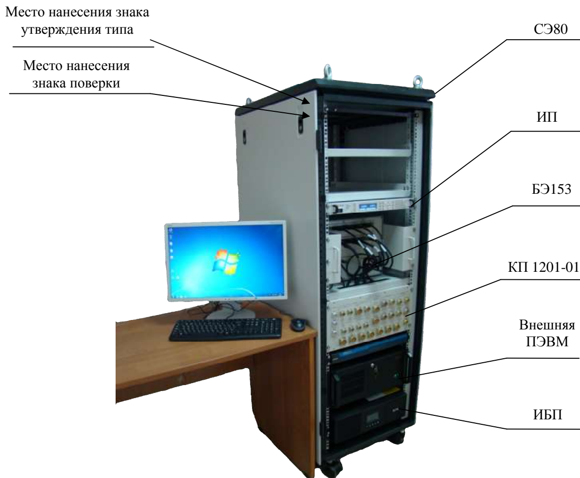
Рисунок 1 – Внешний вид системы ТЕСТ-1201-01 с указанием места нанесения знака утверждения типа и знака поверки
