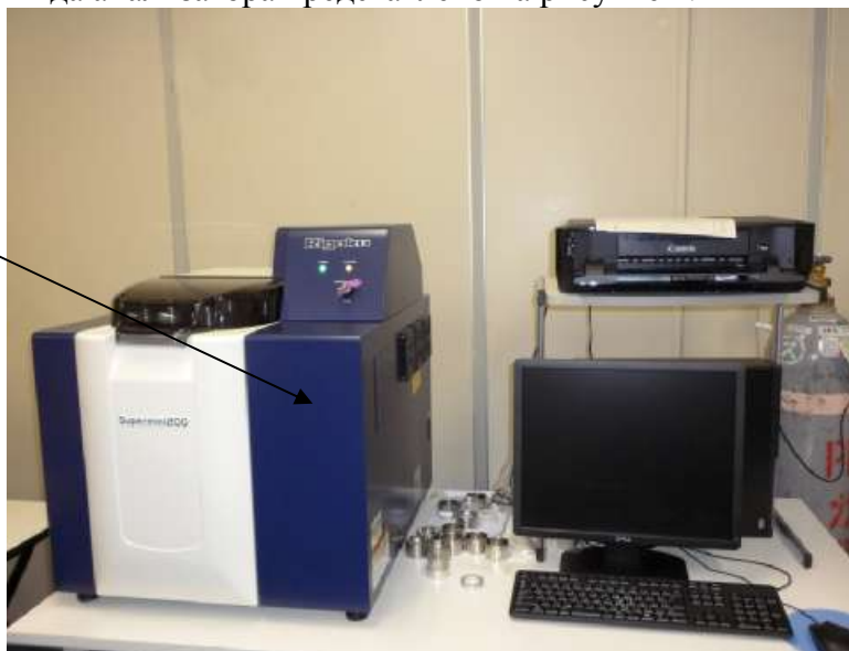
Рисунок 1 – Фото общего вида спектрометра рентгенофлуоресцентного волнодисперсионного Supermini 200
