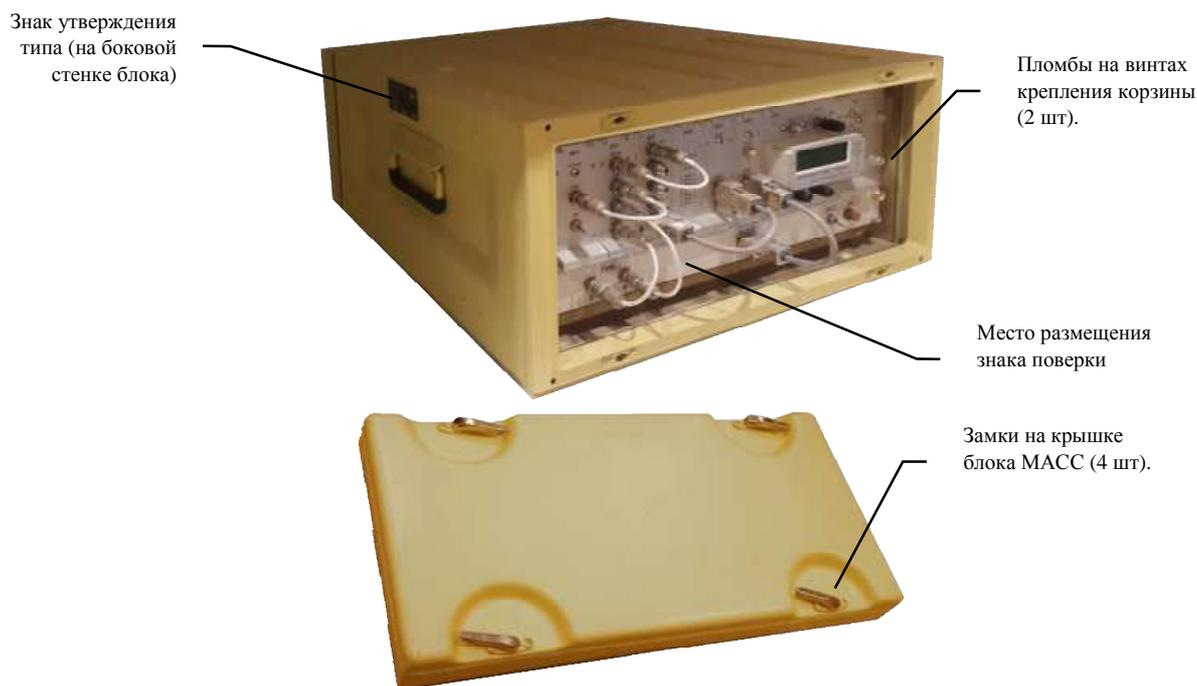
Рисунок 3 – Общий вид блока МАСС
