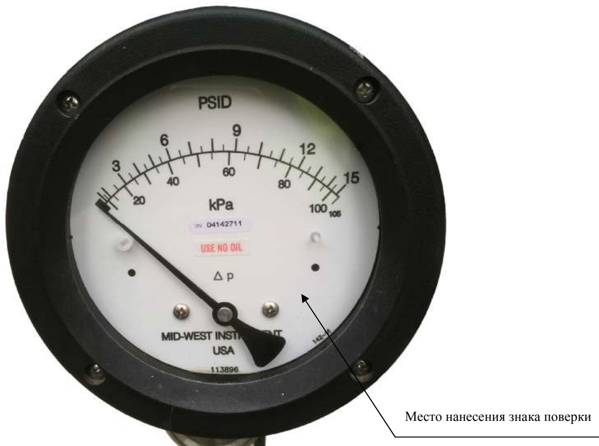
Рисунок 1 - Внешний вид манометра дифференциального 142SC-10-(FTU)O с указанием места нанесения знака поверки
