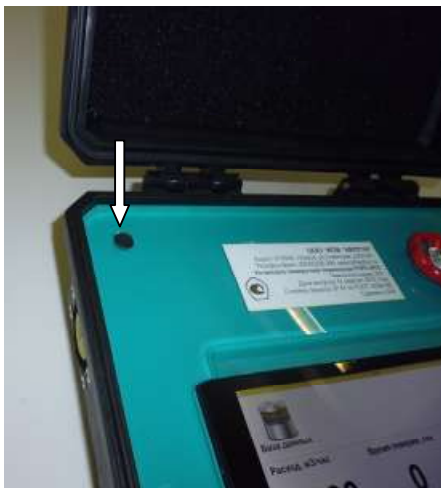
Рисунок 2 – Места нанесения знака поверки на установки поверочные переносные УПРС-П
