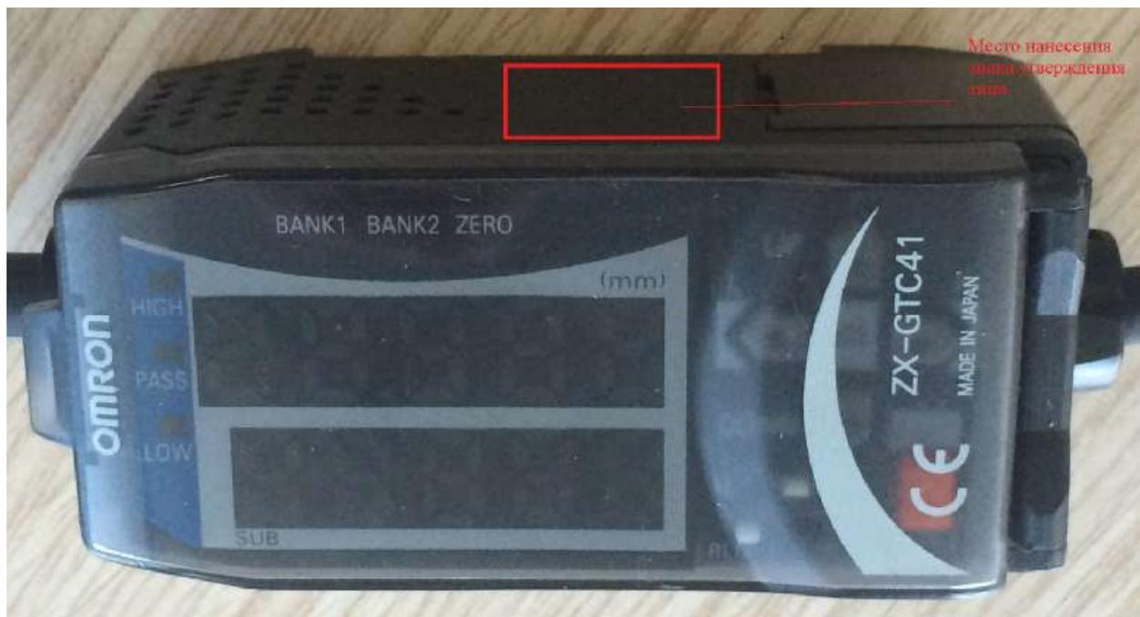
Рисунок 2 - контроллер модели ZX-GTC
