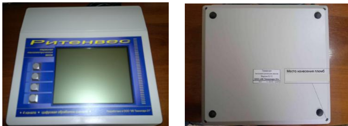
Рисунок 2 – Общий вид и схема пломбирования индикатора Р4-АС
