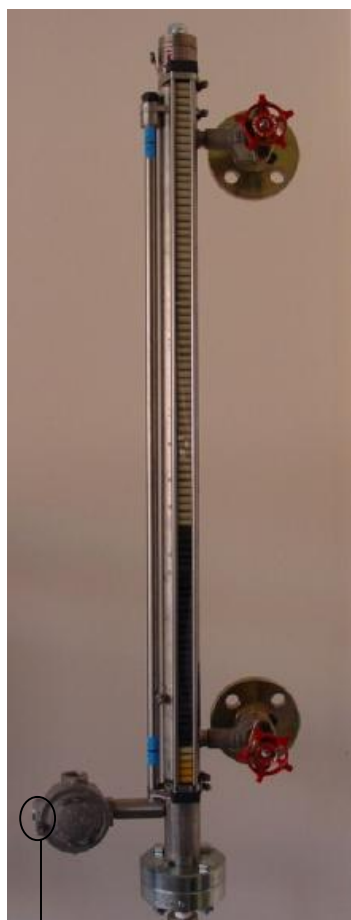
Рисунок 1 – Внешний вид уровнемеров магнитострикционных поплавковых MAG с системой MST
