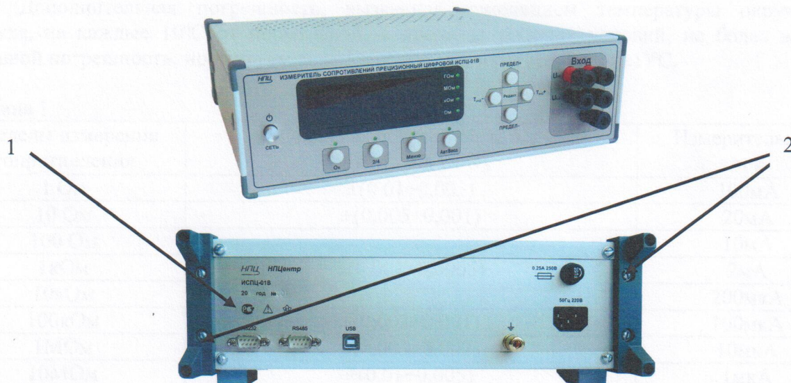
1- место нанесения знака утверждения типа 2 - места пломбировки от несанкционированного доступа Рисунок 1 - Внешний вид измерителя цифрового ИСПЦ-01В
