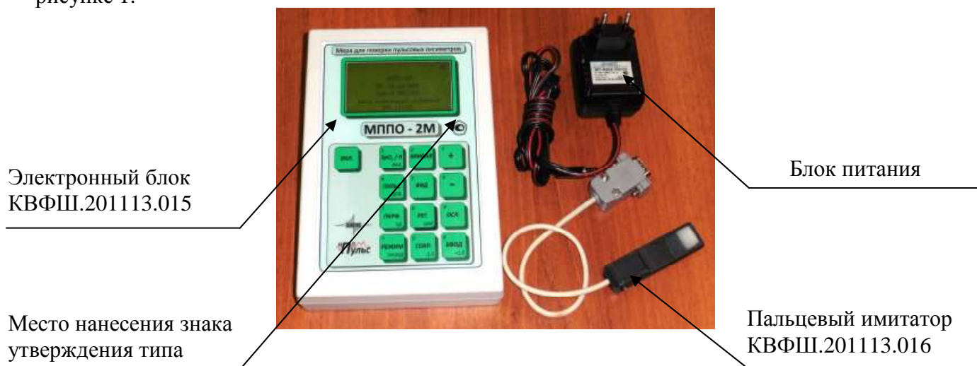
Рисунок 1 - Общий вид меры для поверки пульсовых оксиметров МППО-2М
