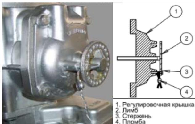
Рисунок 2 – Пломбировка измерителя объема (RSJ-50 и MJ85-S)
