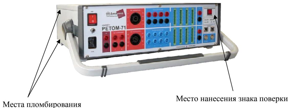
Рисунок 1 - Общий вид комплексов, мест пломбирования и нанесения знака поверки
